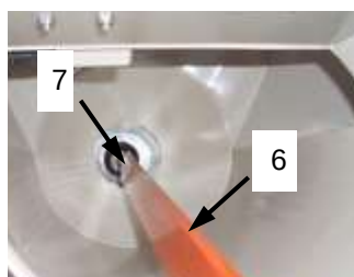
Рис. 59: Опора очищающего вала
