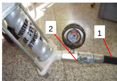
Fig. 11: Соединение шланга для подачи материала
