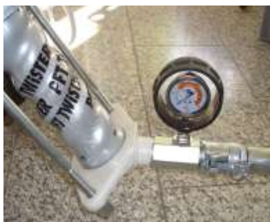
Рис. 39: Манометр давления раствора
