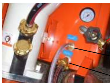
Fig. 10: Соединения подачи воды и воздуха
