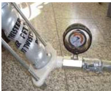
Рис. 39: Манометр давления раствора
