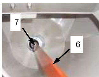
Рис. 59: Опора очищающего вала
