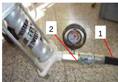
Fig. 11: Соединение шланга для подачи материала
