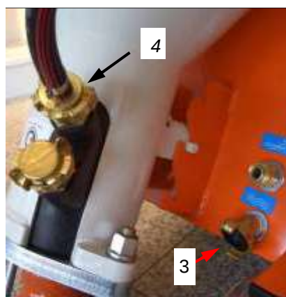
Рис. 33: Подключение подачи воды
