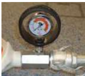
Fig. 23: Манометр давления раствора
