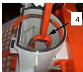
Рис. 57: Выемка смесительной спирали
