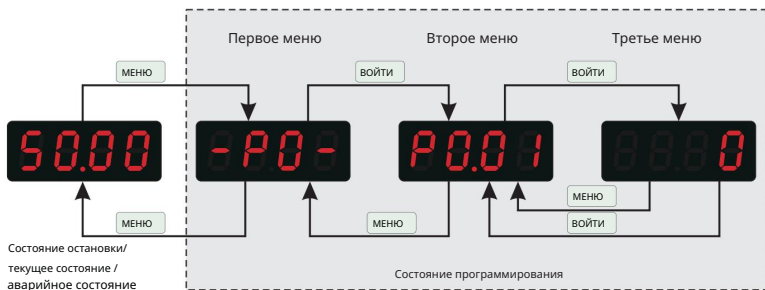
Рисунок 4-6 Состояние программирования панели управления
