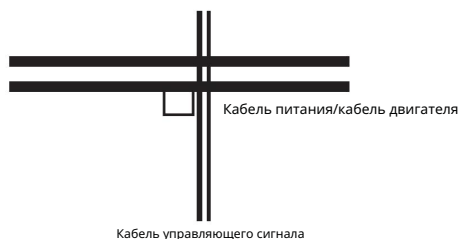
Рисунок 3-14 Требования к проводке системы
